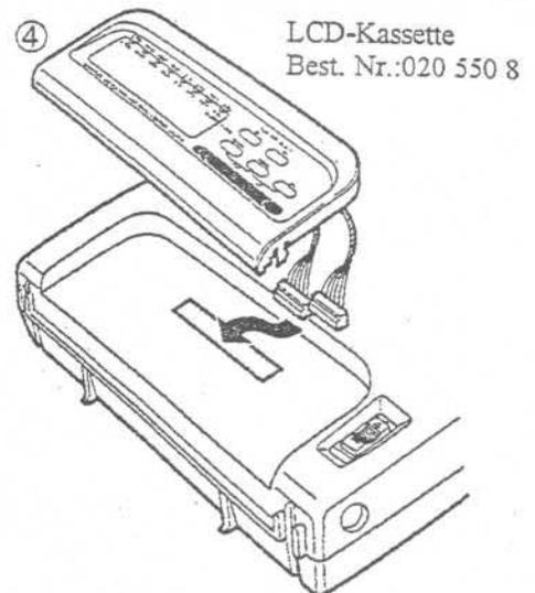
Der Cygnus Sender kann durch Einbau der LCD-Kassette in eine vollwertige MC-Fernsteuerung umgerüstet werden. Dadurch sind zahlreiche Mischer, eine komfortable Bedienung und mehrere Modellspeicher verfügbar. Der Einbau geschieht wie folgt beschrieben. Der Sender muß dabei unbedingt ausgeschaltet sein !!
